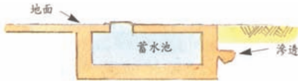
A. 建於室外地下之蓄水池
