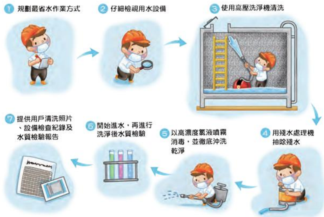
水塔清洗七步驟 (資料來源：臺北自來水事業處)
